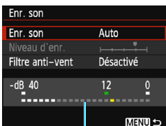
Compteur du niveau
